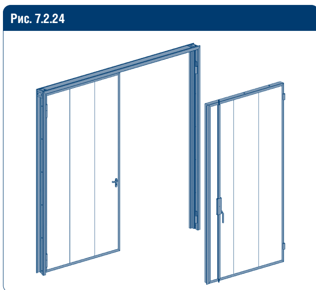
Навесьте створку в сборе с ригельной задвижкой на ось с полупетлей вертикальной стойки. Зазор между створкой и полом должен составлять 20–25 мм. Расположение ригельной задвижки может быть также с наружной стороны открывания ворот.
